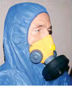
Halbmaske mit auswechselbarem Filter P3
