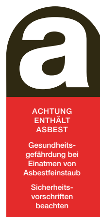
3 Kennzeichen «Achtung Asbest»
