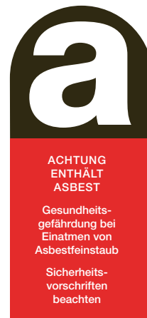
2 Kennzeichen «Achtung Asbest»
