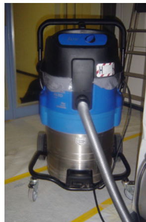
1 Staubsauger der Staubklasse H gemäss EN 60335-2-69, mit Zusatzanforderungen für Asbest
