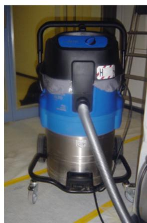
2 Industriestaubsauger mit Filter für Staubklasse H (Asbest)
